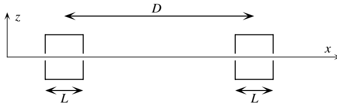
FIG. 17.4: Dispositif pour l'observation des franges de Ramsey.
